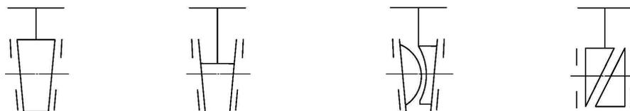
a 型: 楔式刚性闸板      b 型: 楔式弹性闸板      c 型: 楔式双闸板      d 型: 平行式双闸板
